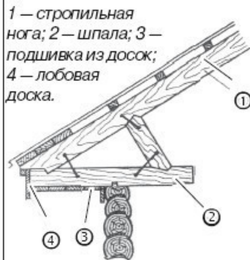
Исполнение опорных узлов стропильных ног с опорой на шпалу и оформление карниза.
