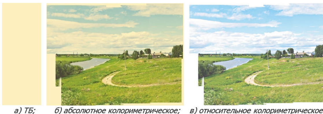
Рис. 2.1. Имитация распечатки принтера на экране монитора с использованием разных колориметрических отображений: а) точка белого, заданная в профиле; б) абсолютное
