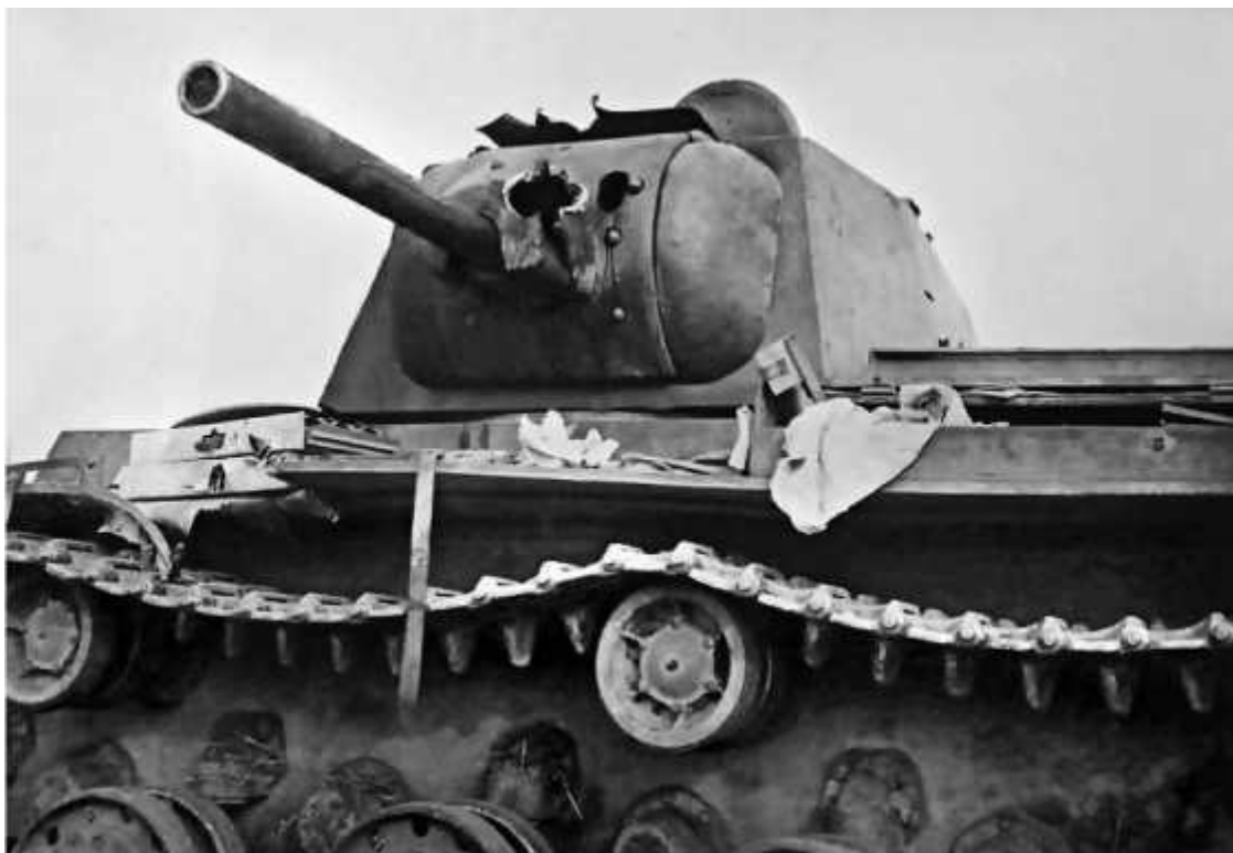
Крупный план поражения маски орудия Л-11 танка КВ-1 ранних серий
