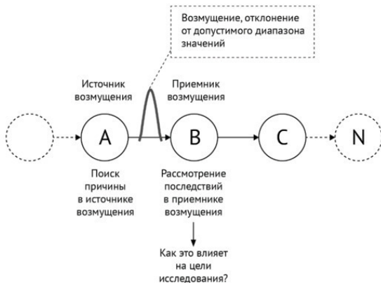
Рис. 5. Принцип метода HAZOP
