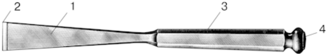
Рис. 27. Части остеотома или долота: 1 – лезвие; 2 – режущая кромка; 3 – рукоятка; 4 – наковаленка (по: Medicon instruments, 1986).
