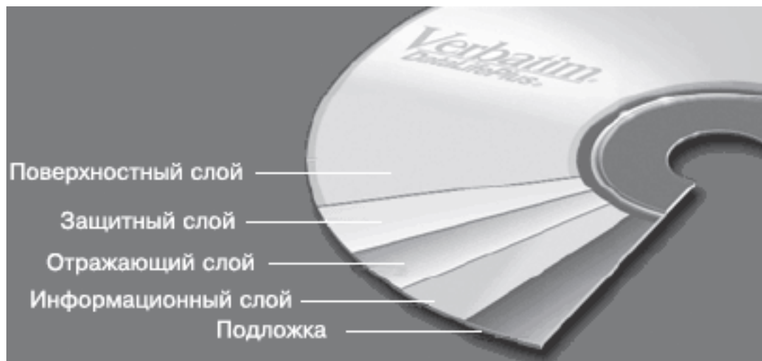
Рис. 1.1. Физическая структура диска CD-R
