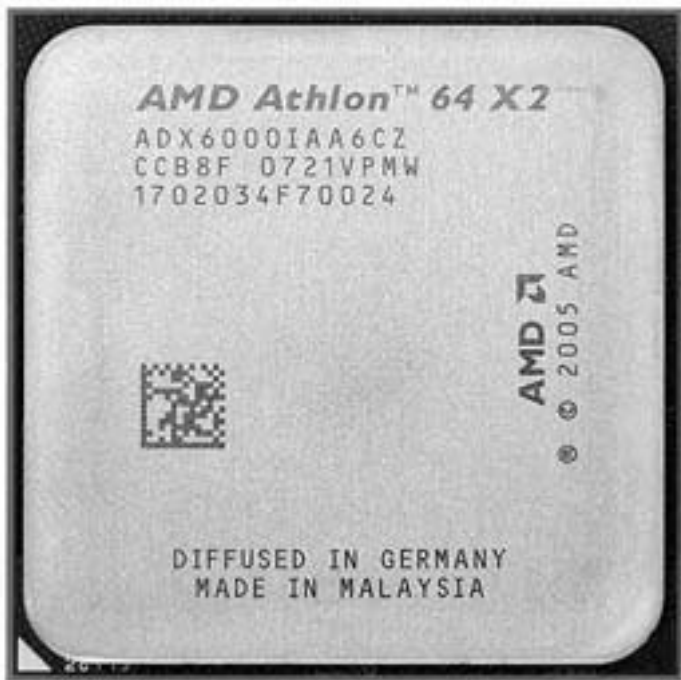
Рис. 2.22. Двухъядерный процессор AMD Athlon 64 X2 6000+
