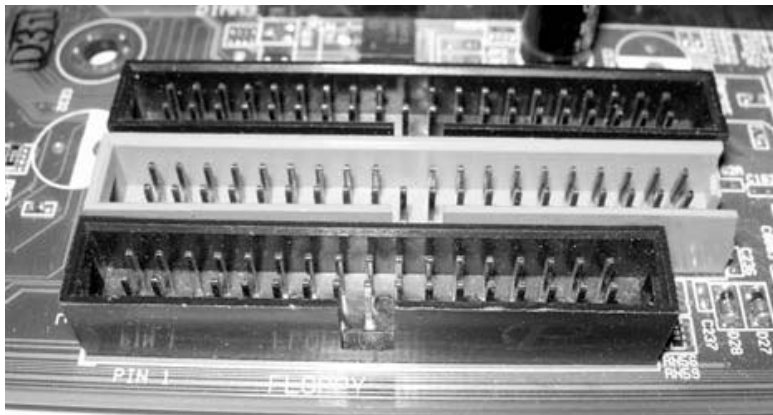
Рис. 2.15. Сверху вниз: IDE-разъемы, FDD-разъем
