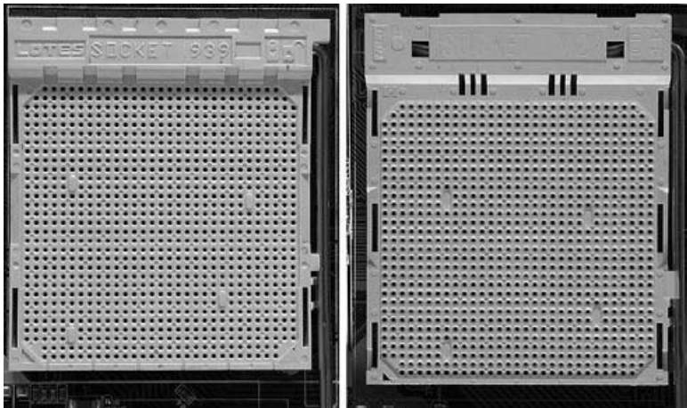
Рис. 2.9. Пример процессорных слотов для процессоров AMD
