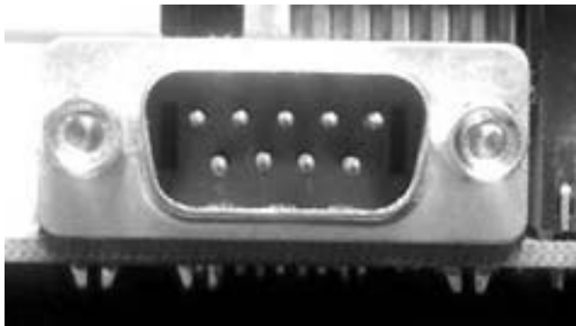
Рис. 2.17. Внешний вид 9-контактного COM-порта
