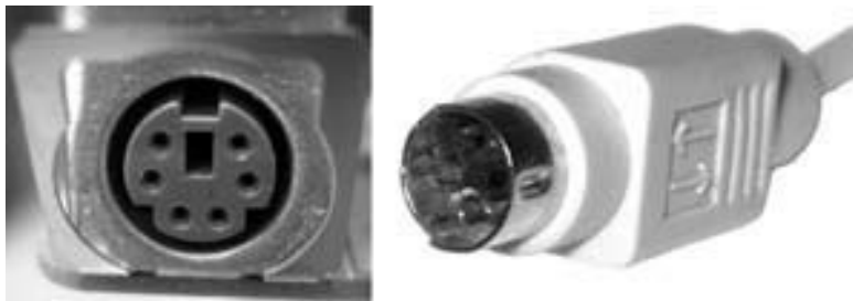
Рис. 2.19. Внешний вид PS/2-порта ( слева ) и PS/2-коннектора ( справа )
