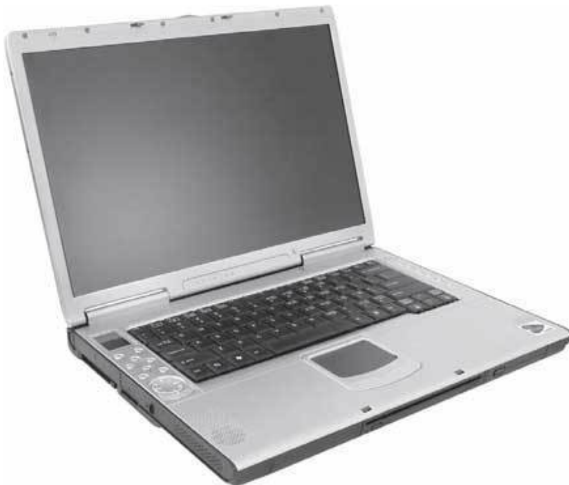
Рис. 3.4. Ноутбуки мультимедиа обычно имеют отдельные клавиши для управления воспроизведением видео– и аудиофайлов
