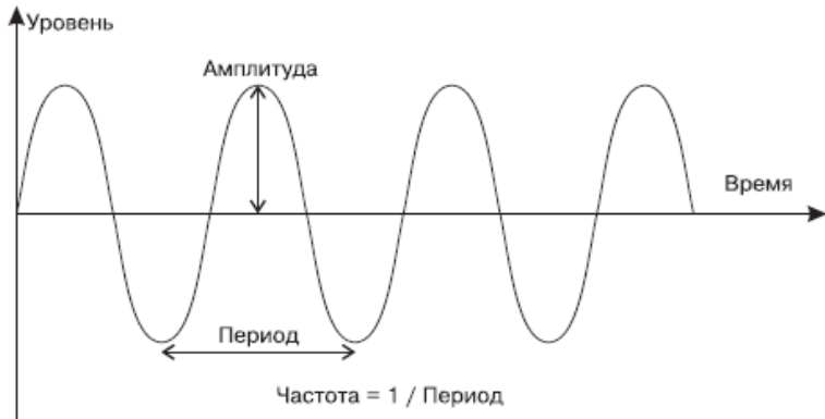
Рис. 1.3. Синусоида – график звуковых колебаний
