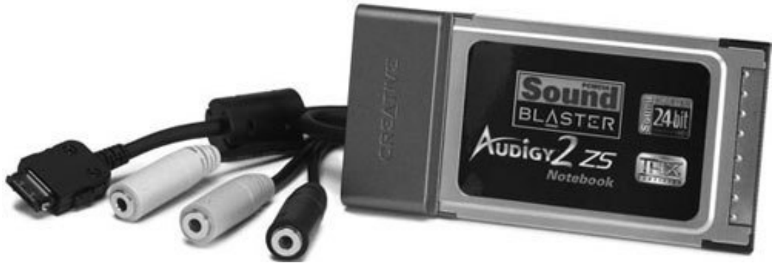
Рис. 4.8. Звуковая карта Creative Audigy ZS в формате PC Card
