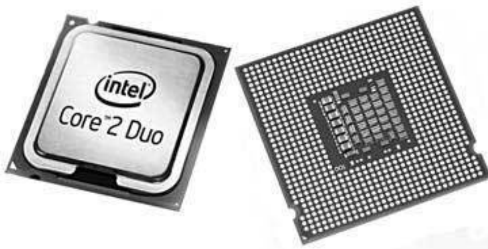
Рис. 2.24. Процессор: лицевая (слева) и обратная (справа) стороны
