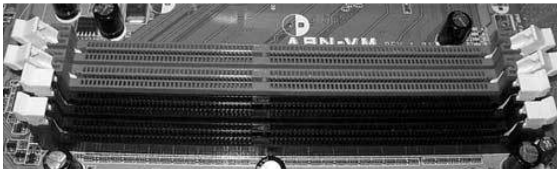
Рис. 2.12. Внешний вид слотов для оперативной памяти
