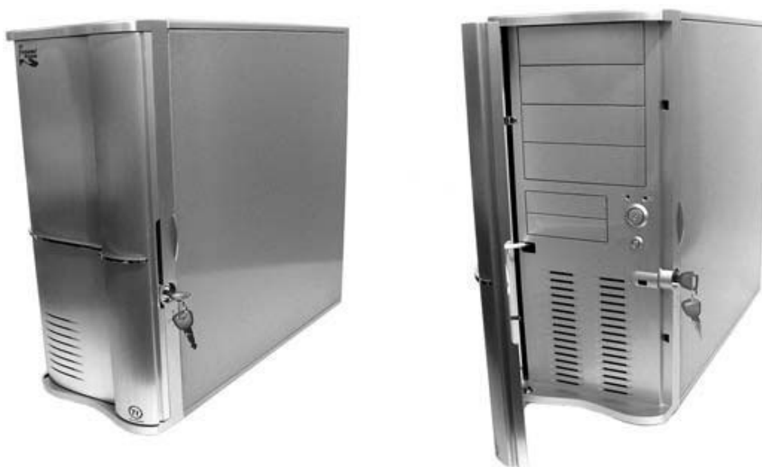
Рис. 2.4. Корпуса типа Midi Tower
