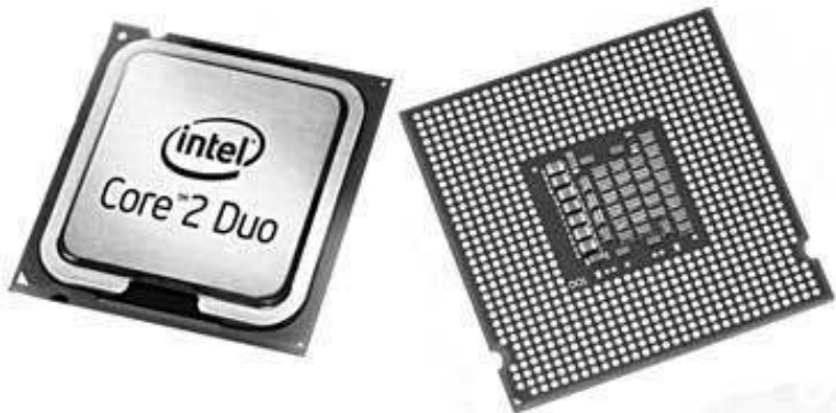
Рис. 2.24. Процессор: лицевая ( слева ) и обратная ( справа ) стороны
