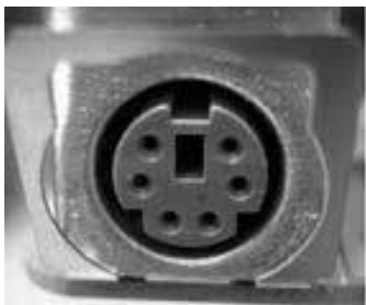
Рис. 2.20. PS/2-порт ( слева ) и PS/2-коннектор ( справа )
