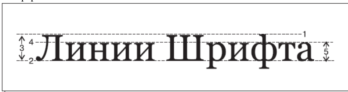
Рис. 1.20. Основные линии шрифта: верхняя линия прописных букв (1) и базовая линия (2) определяют высоту заглавных букв (3), верхняя линия строчных букв (4) и базовая линия определяют высоту строчных букв (5)
