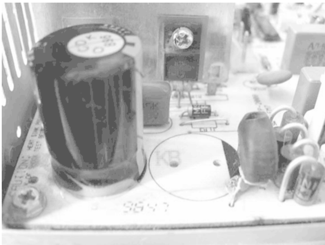
Рис. 1.4. Конденсатор высоковольтного фильтра (обратите внимание: второй конденсатор отсутствует)
