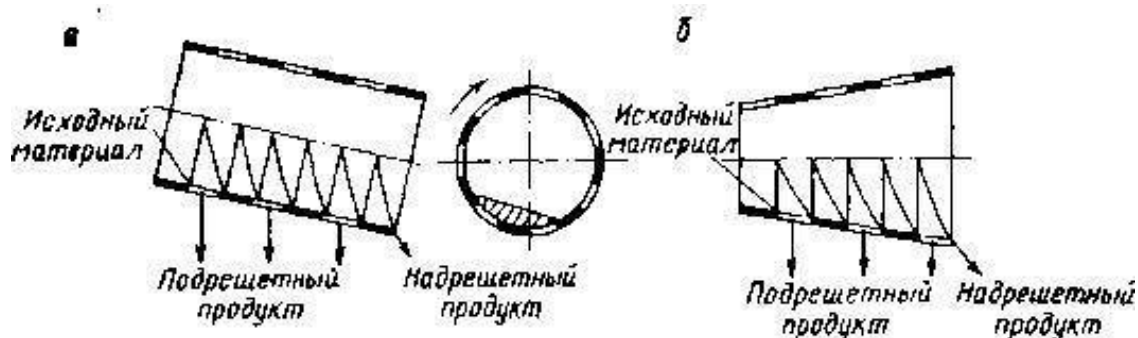
Рис. 2.8. Схемы барабанных грохотов
