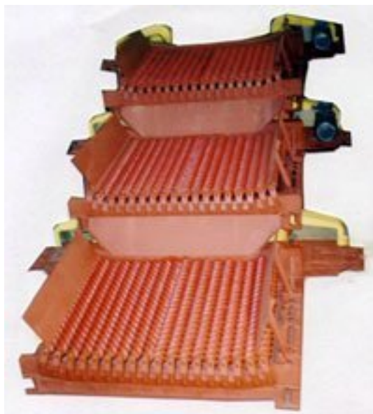
Рис. 2.6. Трехсекционный шнековый грохот ГШ1000
