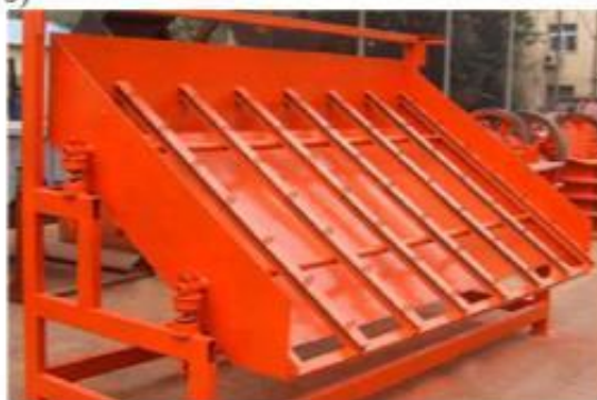
Рис. 1.23. Высокочастотные грохоты для классификации угольных шламов: а – грохот с непосредственным возбуждением сита; б – поличастотный грохот; в – репульпирующий грохот Деррика; г – грохот Stack Sizer TM ; д – типа ZGP-S
