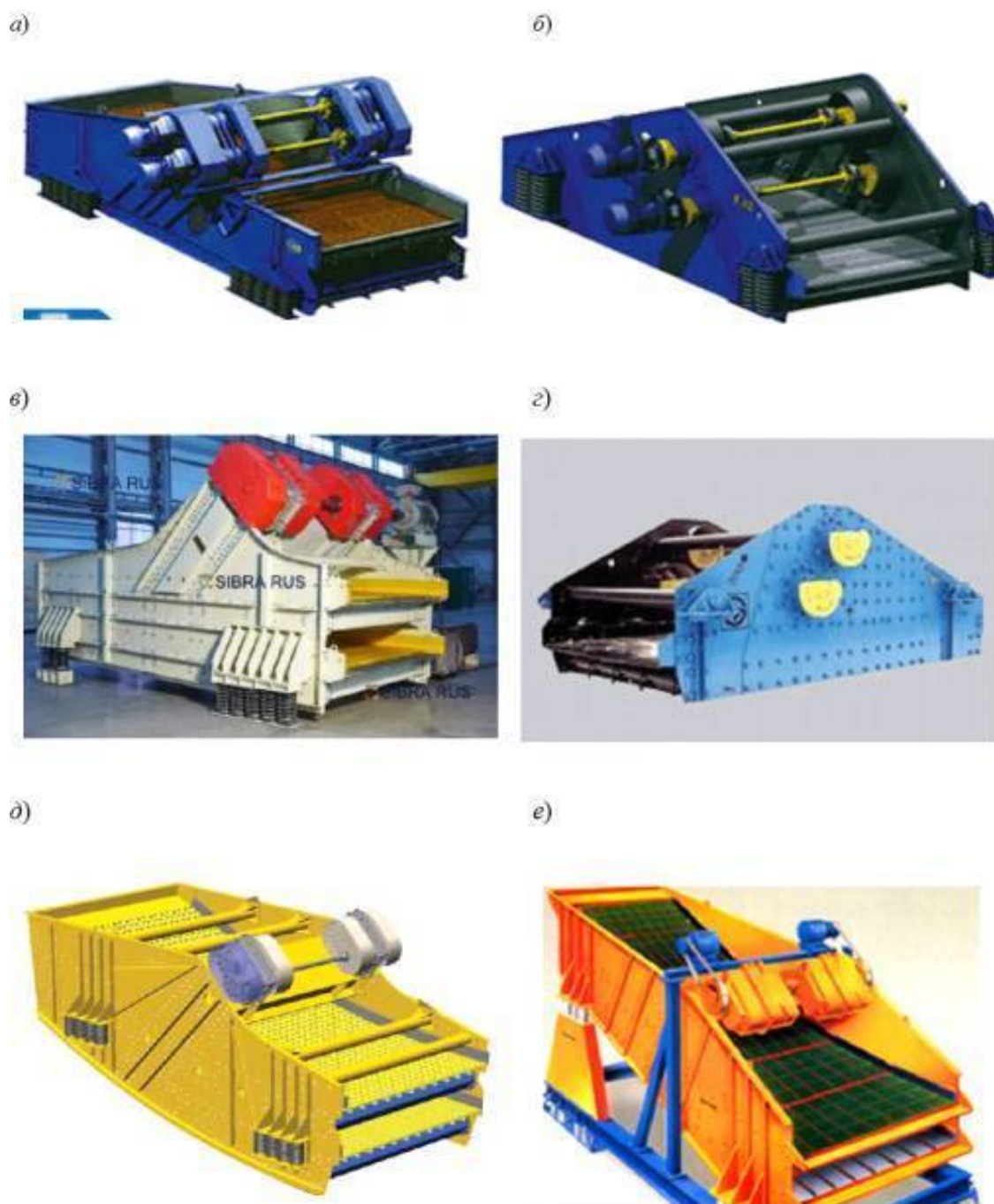
Рис. 1.16. Грохоты для мокрого подготовительного грохочения угля: а – типа ГИСТ; б – типа ГИС; в – типа ГИСЛ; г – типа ГВЧ; д – типа «Банан»; е – типа «Тabor»
