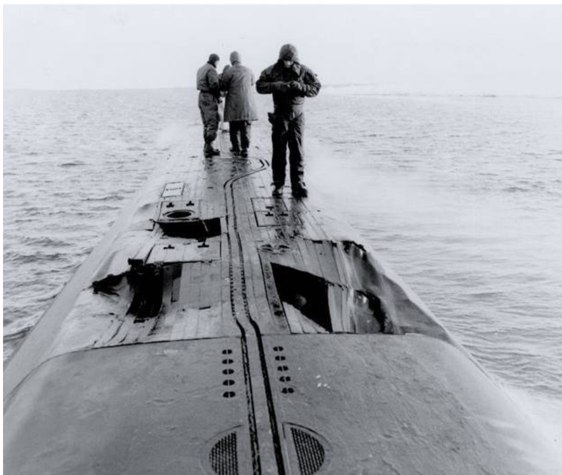
Повреждения корпуса АПЛ Sargo (SSN-583), полученные в ходе всплытий через лёд
