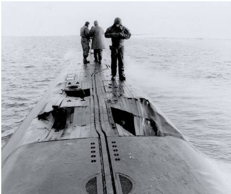
Повреждения корпуса AHT Sargo (SSN-583), полученные в ходе всплытий через лёд
