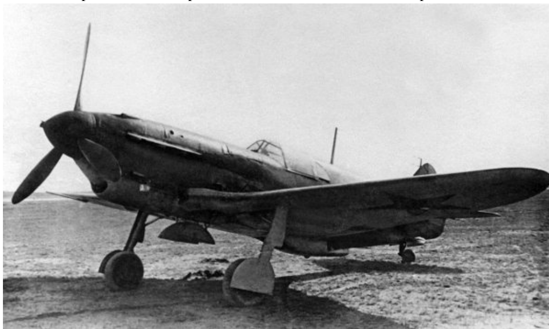
ЛаГГ-3 первых серий с убирающимся хвостовым колесом
