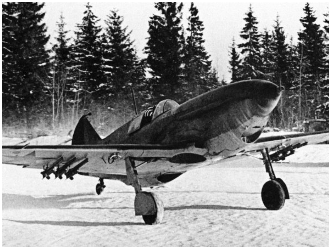
ЛаГГ-3 с реактивными снарядами РС-82 под крылом
