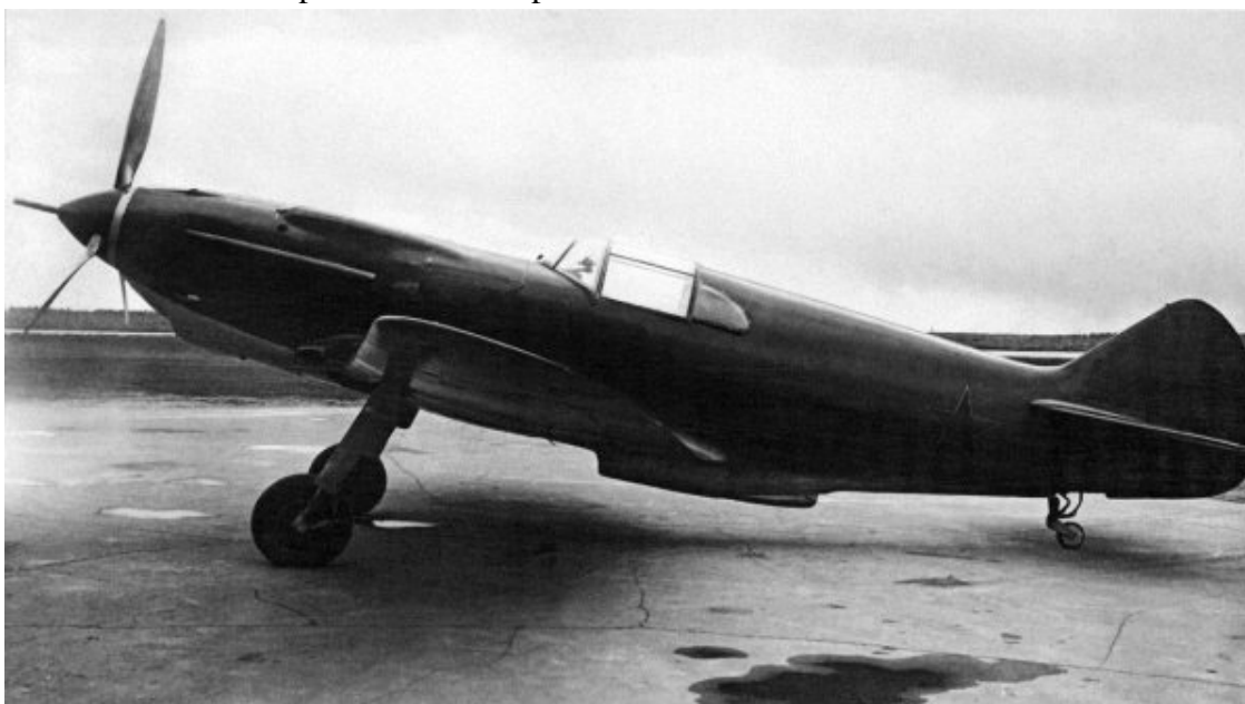
Истребитель К-37 с пушкой калибра 37 мм, переделанный из ЛаГГ-3 завода № 23
