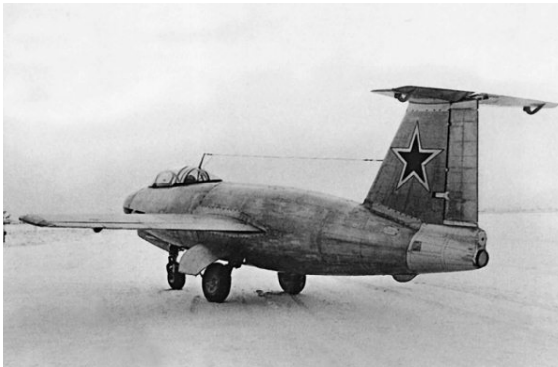
Опытный ракетный перехватчик И-270 с ЖРД
