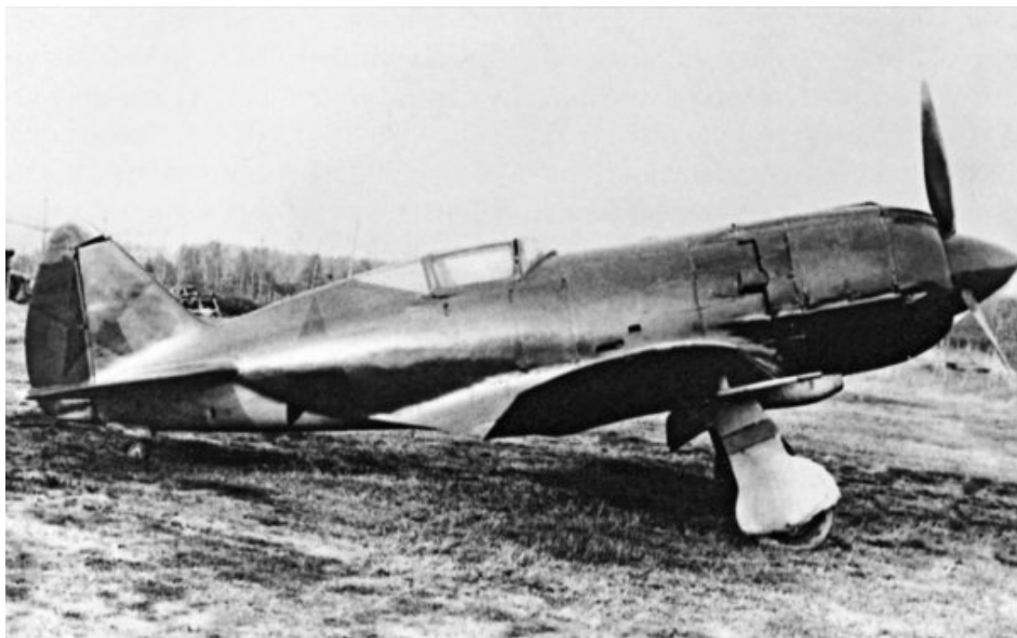
Опытный истребитель И-210 с мотором М-82
