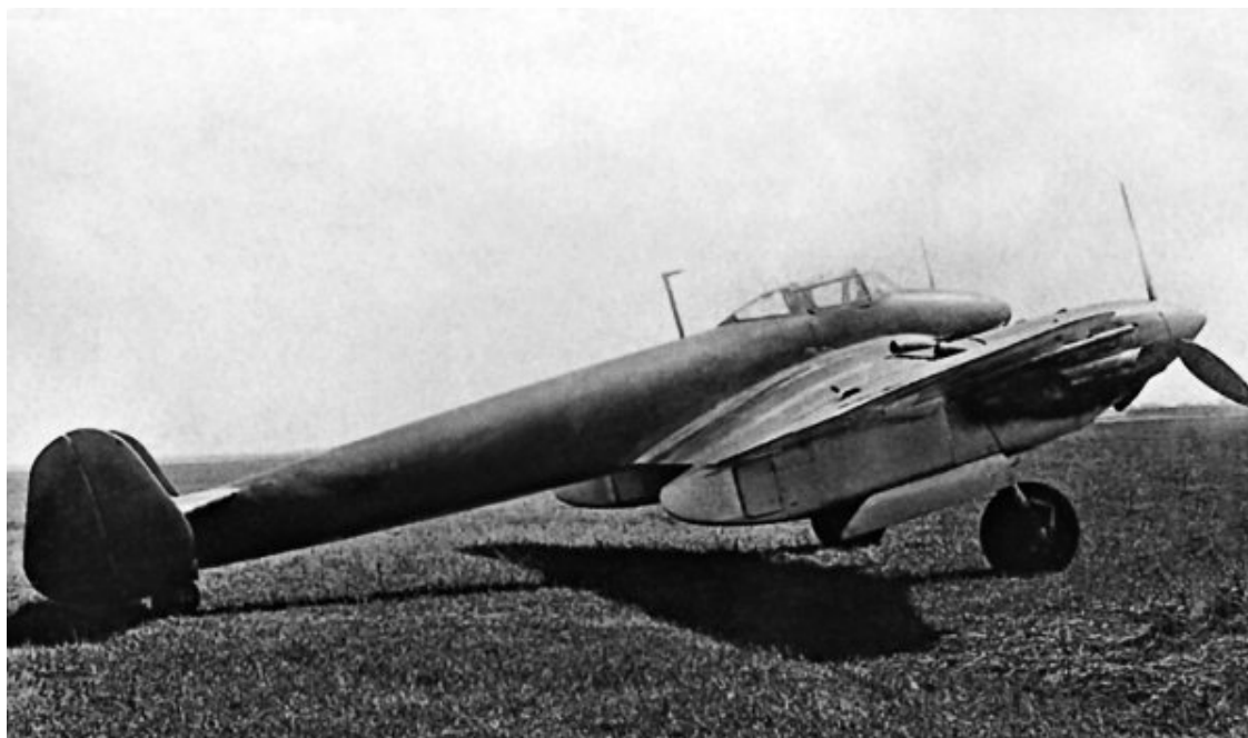
Двухмоторный истребитель сопровождения ДИС-200 с двигателями АМ-37
