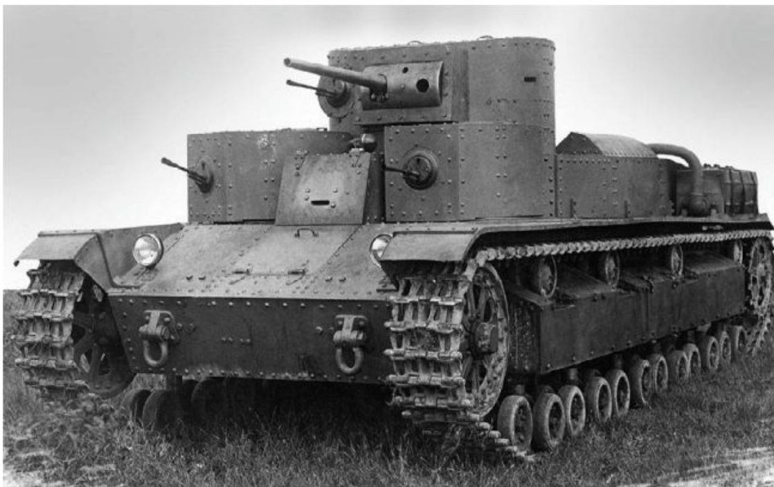
Прототип Танка Т-28 на заводских испытаниях. Июль 1932 года. Хорошо видно, что в башне установлено не 45-мм, а 37-мм пушка Б-3.
