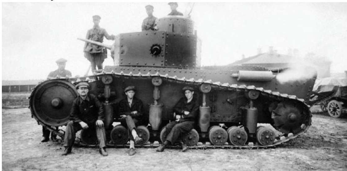
Танк Т-12 во время испытаний. Район Харькова, июль 1930 года. Машина уже имеет штатное вооружение – 45-мм пушку и три пулемета ДТ.
