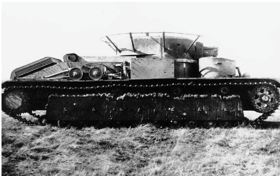
Танк Т-28 выпуска 1936 года, вид справа. Хорошо видна укладка ЗИПа – запасная тележка опорных катков, домкраты, кирка, трос.
