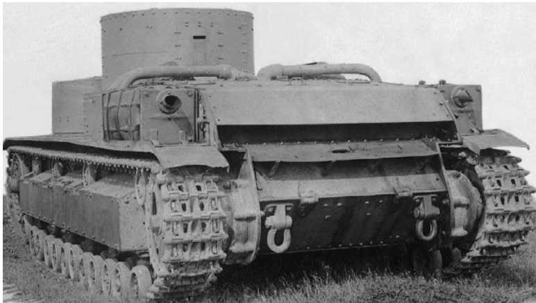
Прототип танка Т-28 на заводских испытаниях, вид сзади. Июль 1932 года.
