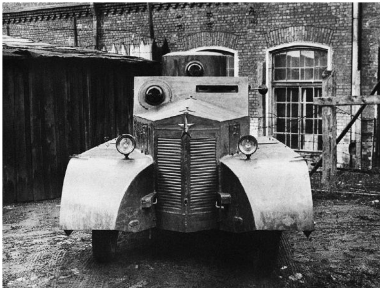
Бронеавтомобиль БАД-1, вид спереди. Хорошо видна конструкция жалюзи защиты ради-
