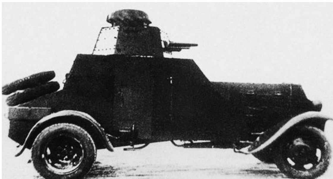
Бронеавтомобиль БА-27 на шасси «Форд-АА». Москва, зима 1930 года (фото из архива Я. Магнуского).
