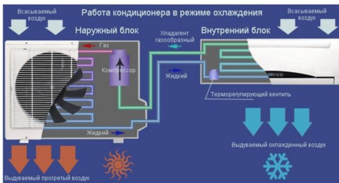
Рис. 3.15. Принцип работы кондиционера в режиме охлаждения 11
