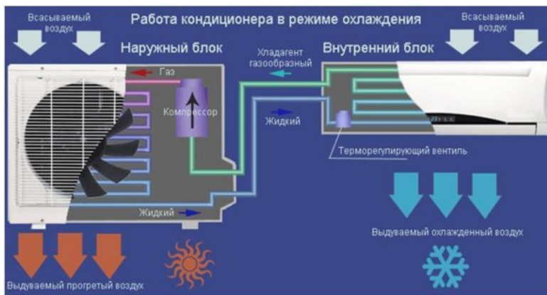
Рис. 3.15. Принцип работы кондиционера в режиме охлаждения 11
