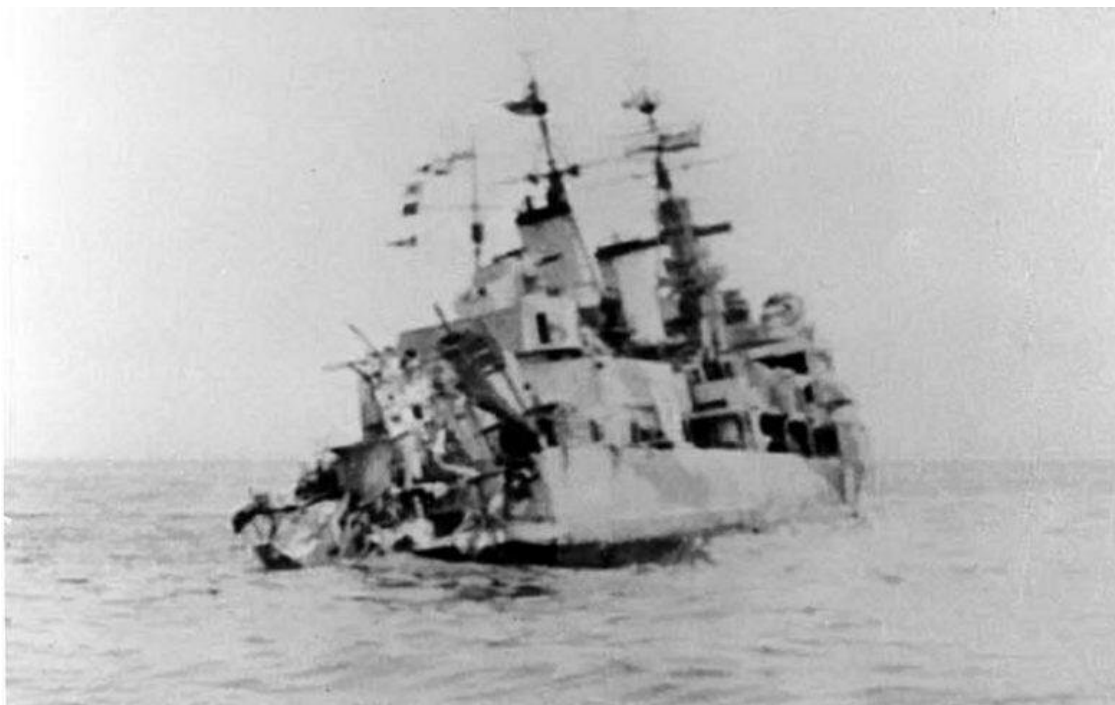
Снимок сделан со стороны кормы «Эдинбурга», поврежденной торпедой. Виден масштаб повреждений.
