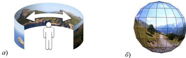
Рис. 1.1. Цилиндрическая ( а ) и сферическая ( б ) фотопанорама (илл. с сайтов https://virtual-tour-360.ru и http://visual360.ru )
