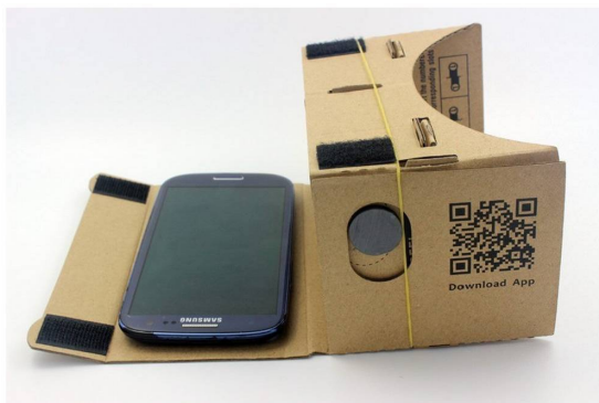
Рис. 1.5. Картонный шлем виртуальной реальности на базе смартфона (фото https://cardboard.lpg.tf/lpg_images/10420/16204/7291b96521036f33258fdd45bf87b162.jpg )
