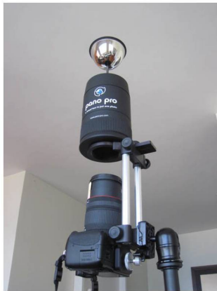
Рис. 1.4, з. Панорамная насадка на обычную камеру (фото http://samovarchik.info/img/preview/724_600.jpg )
