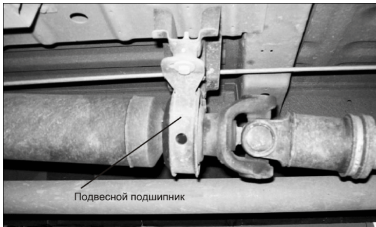
Рис. 1.3. Длинный карданный вал с подвесным подшип-
