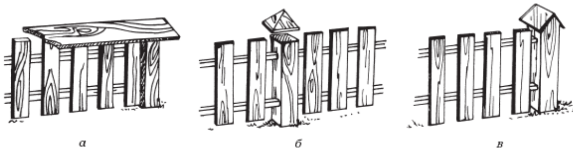
Рис. 25. Варианты конструкции наверхий: а) наверхия-доски, установленные под углом 15^\circ ; б) крышка и колпак для защиты отдельных столбов; в) наверхие из листового железа, согнутого «домиком»
