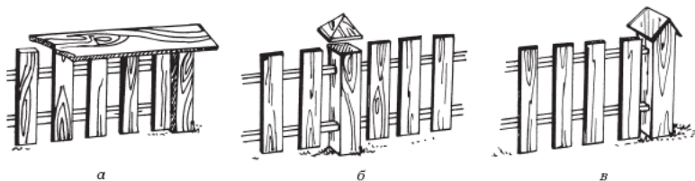
Рис. 25. Варианты конструкции наверший: а) навершия-доски, установленные под углом 15^\circ ; б) крышка и колпак для защиты отдельных столбов; в) навершие из листового железа, согнутого «домиком»
