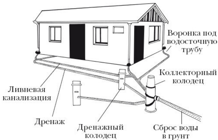
Рисунок 1. Конструирование дренажной системы
