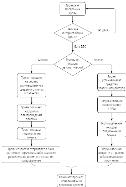
Рис. 1.4. Блок-схема хищения денежных средств с помощью троянской программы
