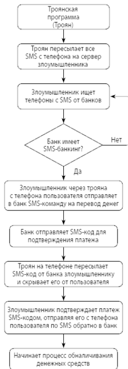
Рис. 1.8. Блок-схема хищения денежных средств с помощью троянской программы на мобильном устройстве
