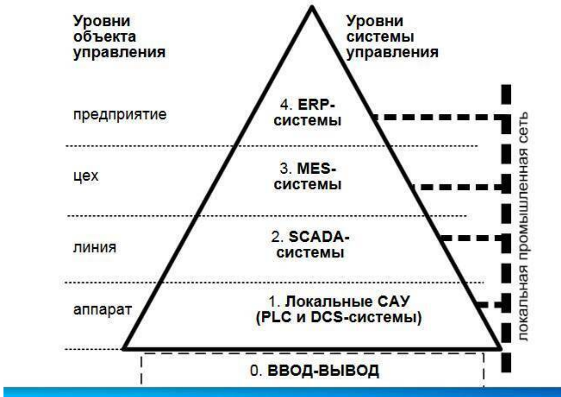
Рис.2.1 Уровни интегрированной системы автоматизации производства
