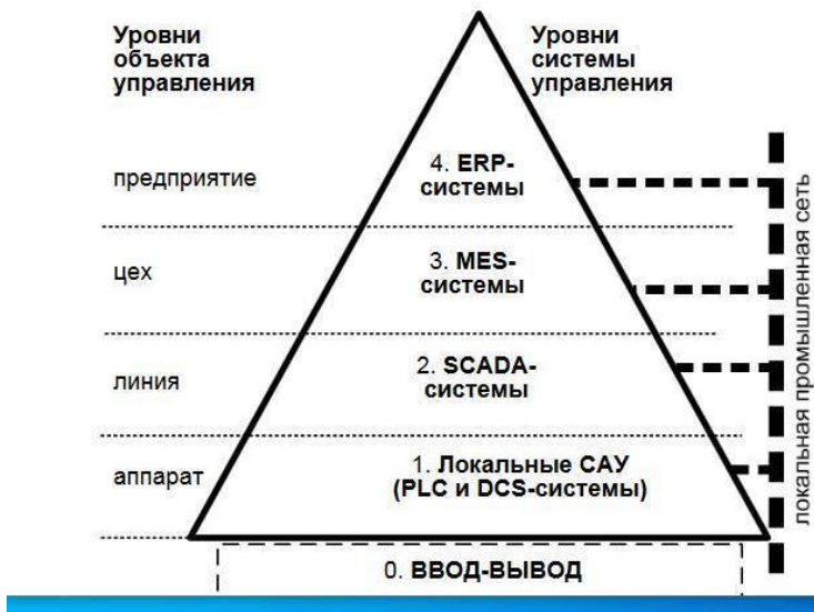
Рис.2.1 Уровни интегрированной системы автоматизации производства
