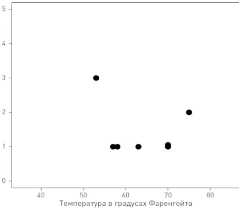
Число уплотнительных колец, достигших критического состояния, при каждом запуске
