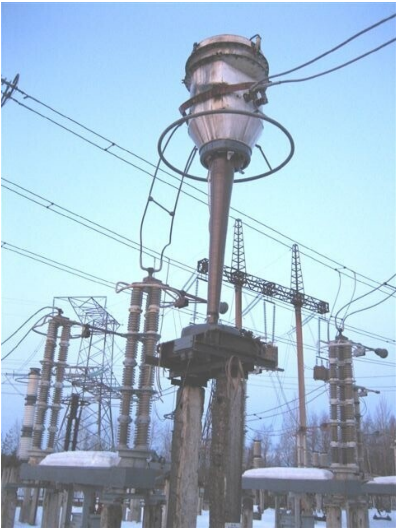
Рис. 1.24. Повреждение фазы «С» ТТ-330 кВ типа ТФРМ на подстанции 330 кВ.
