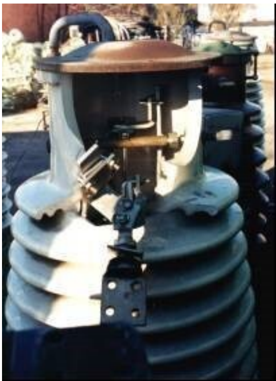
Рис. 1.20. Поврежденный ТТ-110 кВ с обнаруженным за 6 месяцев до взрыва перегревом величиной T = 0,8C .
