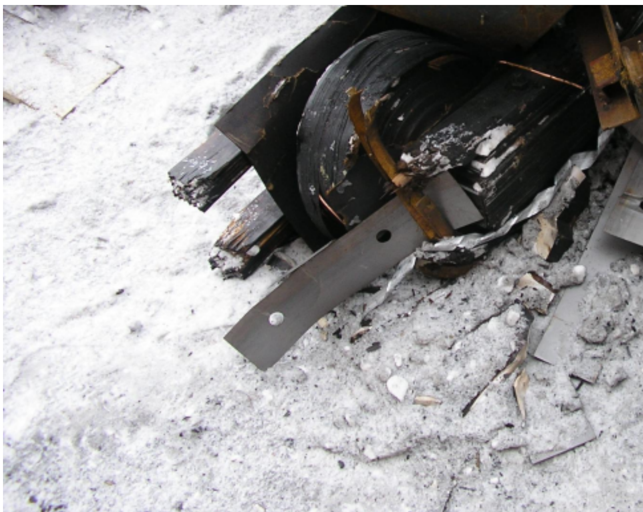
Рис. 1.28. Разрушение ТН типа НКФ-110 при подаче на него рабочего напряжения после нахождения под воздействием процесса феррорезонанса: а) обмотки ТН, б) следы пожара после замены ТН на новые.
