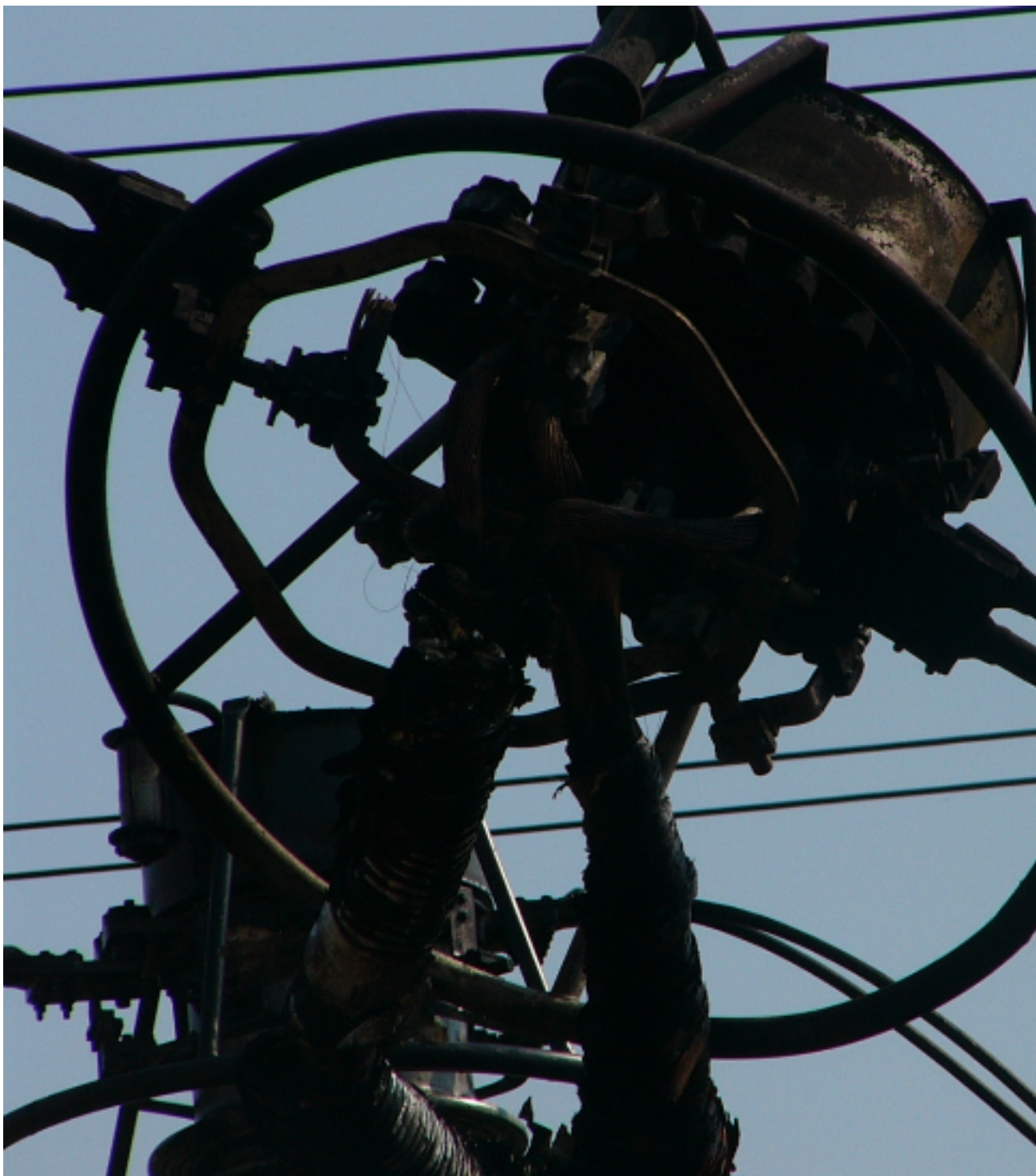
Рис. 1.22. Повреждение ТТ типа ТФКН-330 кВ подстанции 330 кВ из-за внутреннего замыкания вследствие старения и износа изоляции.
