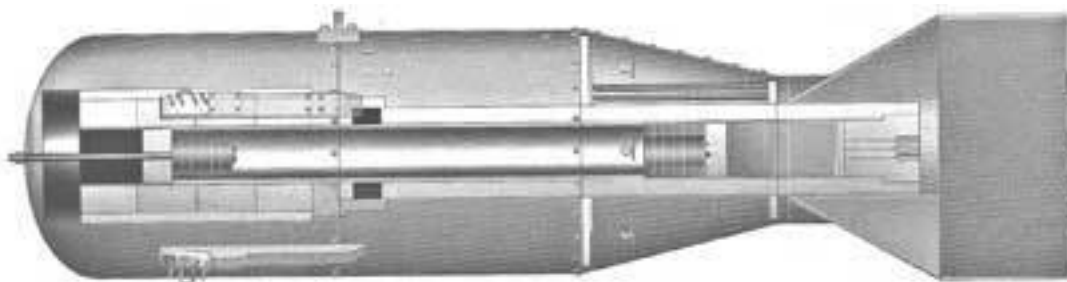
Урановая бомба «Малыш» – «пушечная» конструктивная схема (см. [5], с. 49)
