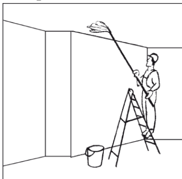
Рис. 8. Размывка потолка
