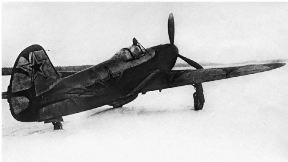
Як-3 с фотокинопулеметом С-13 на аэродроме ЛИИ
