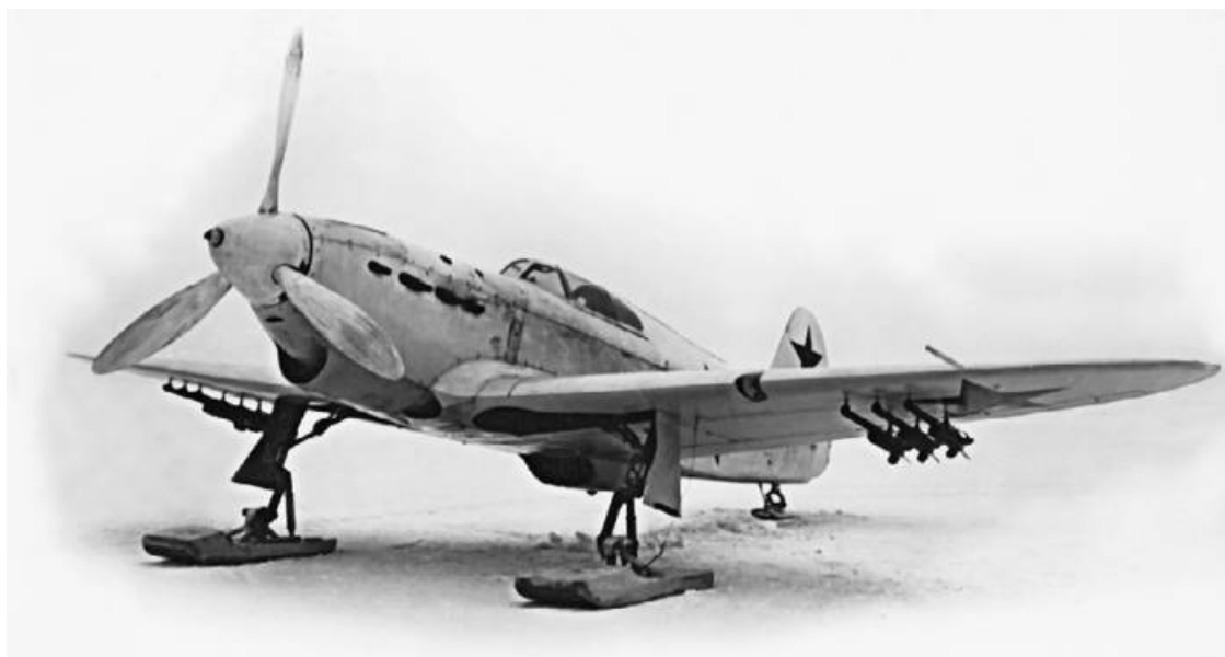
Як-1 на лыжном шасси и с реактивными снарядами РС-82 под крылом
