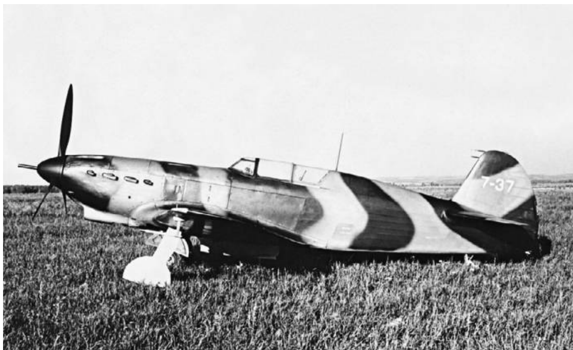
Истребитель Як-7-37 с 37-мм пушкой Ш-37 Б.Г. Шпитального
