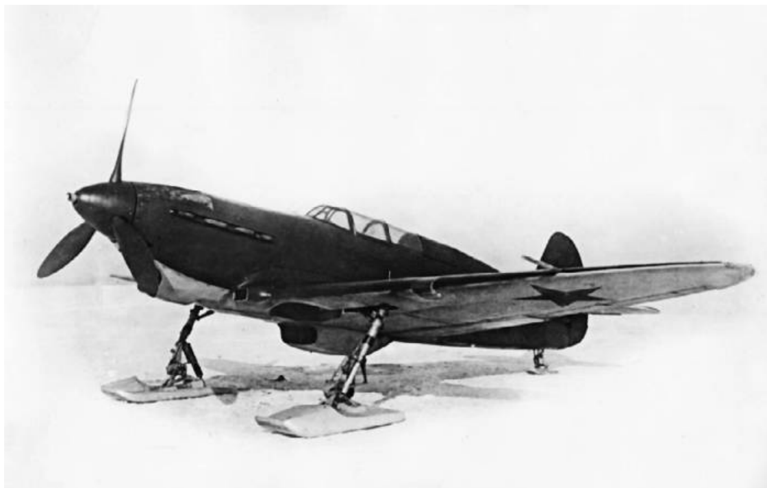
Як-7А с мотором М-105П (заводской № 1411, завод № 153) на лыжах на аэродроме НИИ ВВС. Февраль 1942 г.
