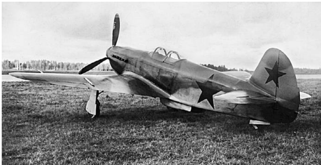
Як-1М «Дублер» завода № 115 с М-105ПФ винтом ВИШ-105СВ01 в НИИ ВВС. Построен в сентябре, фото сделано в октябре 1943 года
