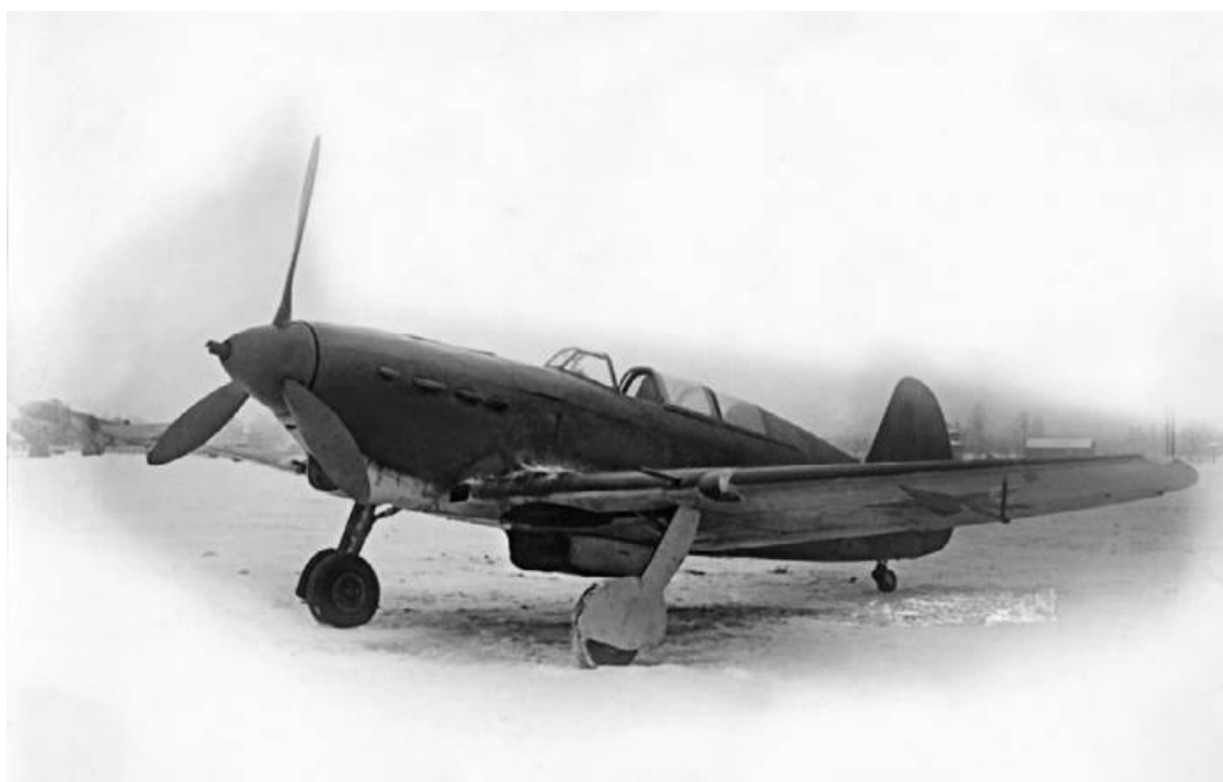
Як-7М с мотором М-105 (выпущен заводом № 301 и модифицирован на заводе № 115). Декабрь 1941 г.
