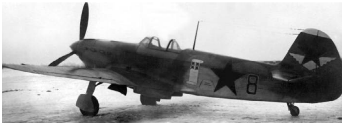
Як-7Б летчика Шинкаренко с пониженным гаргротом. Самолет доработан в 42-м иап
