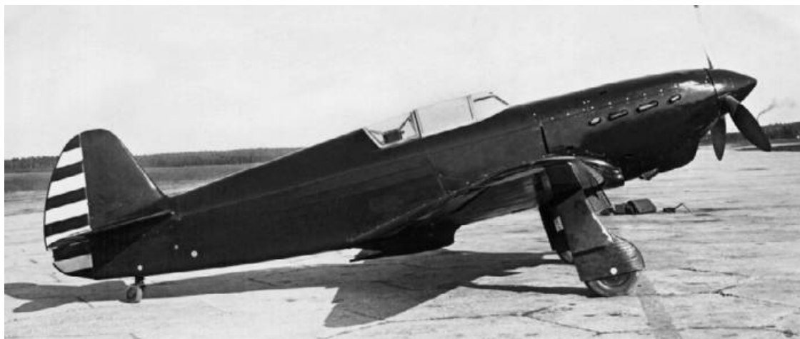
И-26-2 – второй прототип Як-1 с мотором М-105П и винтом ВИШ-61
