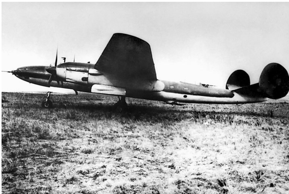
Первый вариант дальнего высотного бомбардировщика ДВБ-102 с моторами М-120
