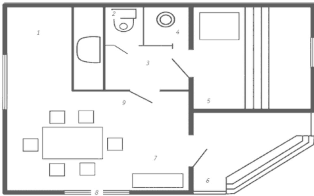
Рис. 5 План размещения бани с совмещением предбанника и моечной с санузлом
