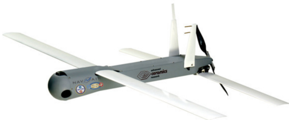
Фото 14. БПЛА «Coyote» (Койот). Длина-790мм, размах крыльев-1200мм, масса-6,4кг, скорость – до 120км/ч, максимальная дальность-до 35км. Фото с сайта vrk.name
