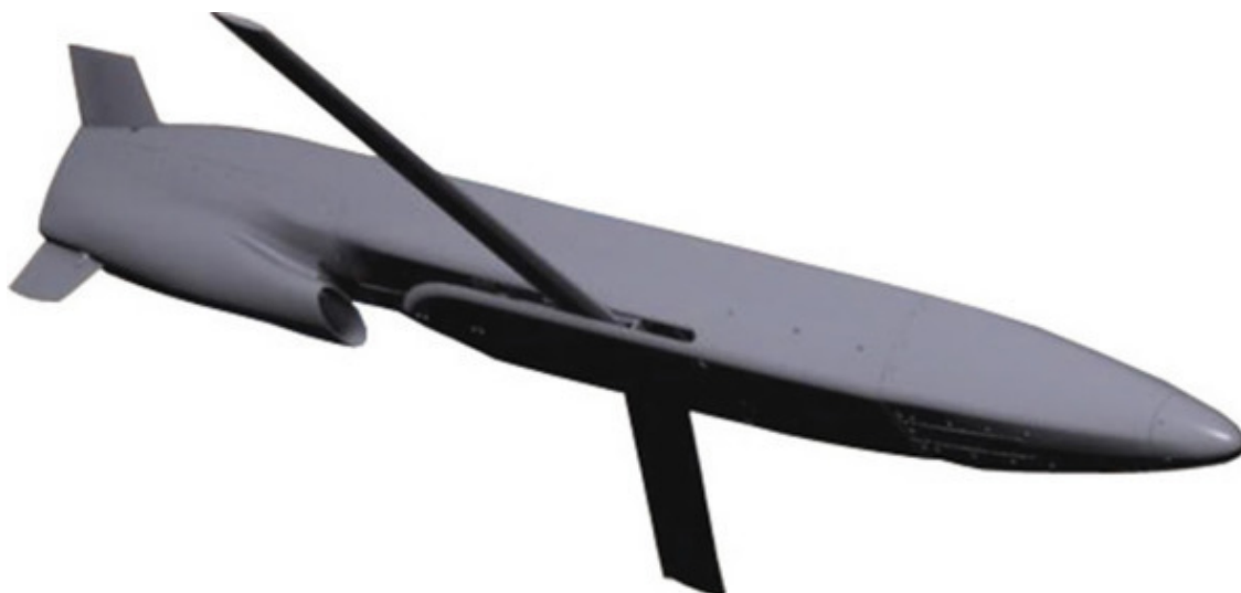
Фото 29. Ложная цель- постановщик помех ADM-160 MALD (источник https://yanziyang.files.wordpress.com/2014/05/ord_mald_decoy_concept_lg.jpg )
