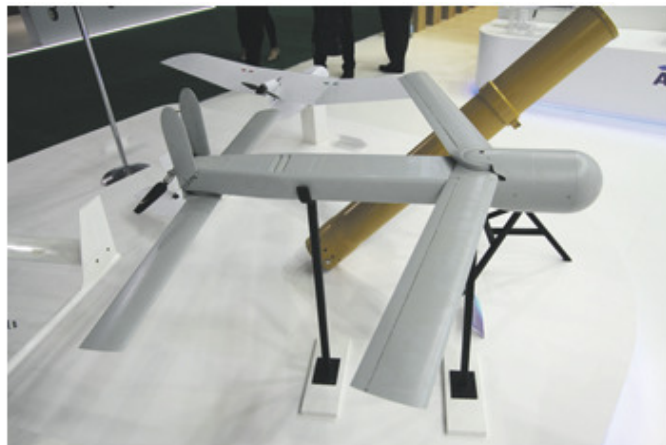
Фото 15. БПЛА SN-901. Длина 1200мм, масса 9кг. Максимальная скорость-до 150км/ч, дальность действия 15км. (Фото с urk.name )
