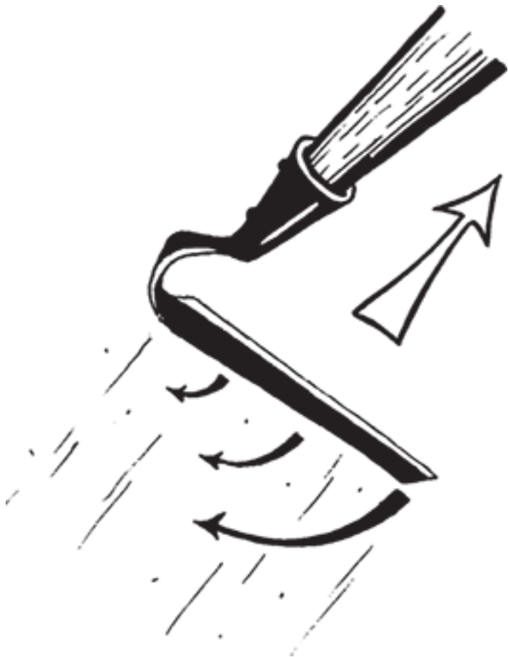
Рис. 5. Плоскорез Фокина: при проводке за счет рычага возникает вращательная сила
