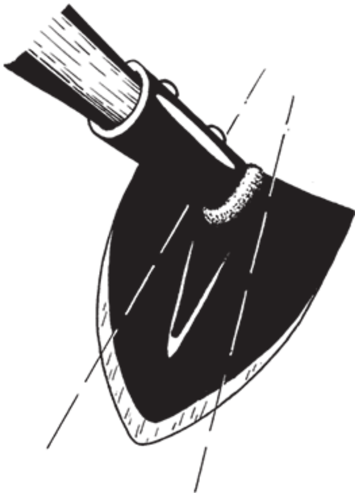
Рис. 3. Превращать кондовые пропашники в замечательные тяпки для дернины – одно удовольствие: два спила – и
