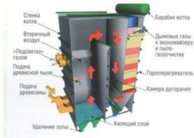
Котел со сжиганием топлива в кипящем слое
