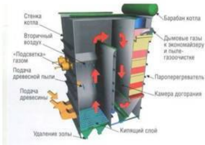
Котел со сжиганием топлива в кипящем слое
