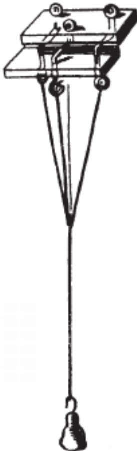
Рис. 16. Машинка для сучения лес
