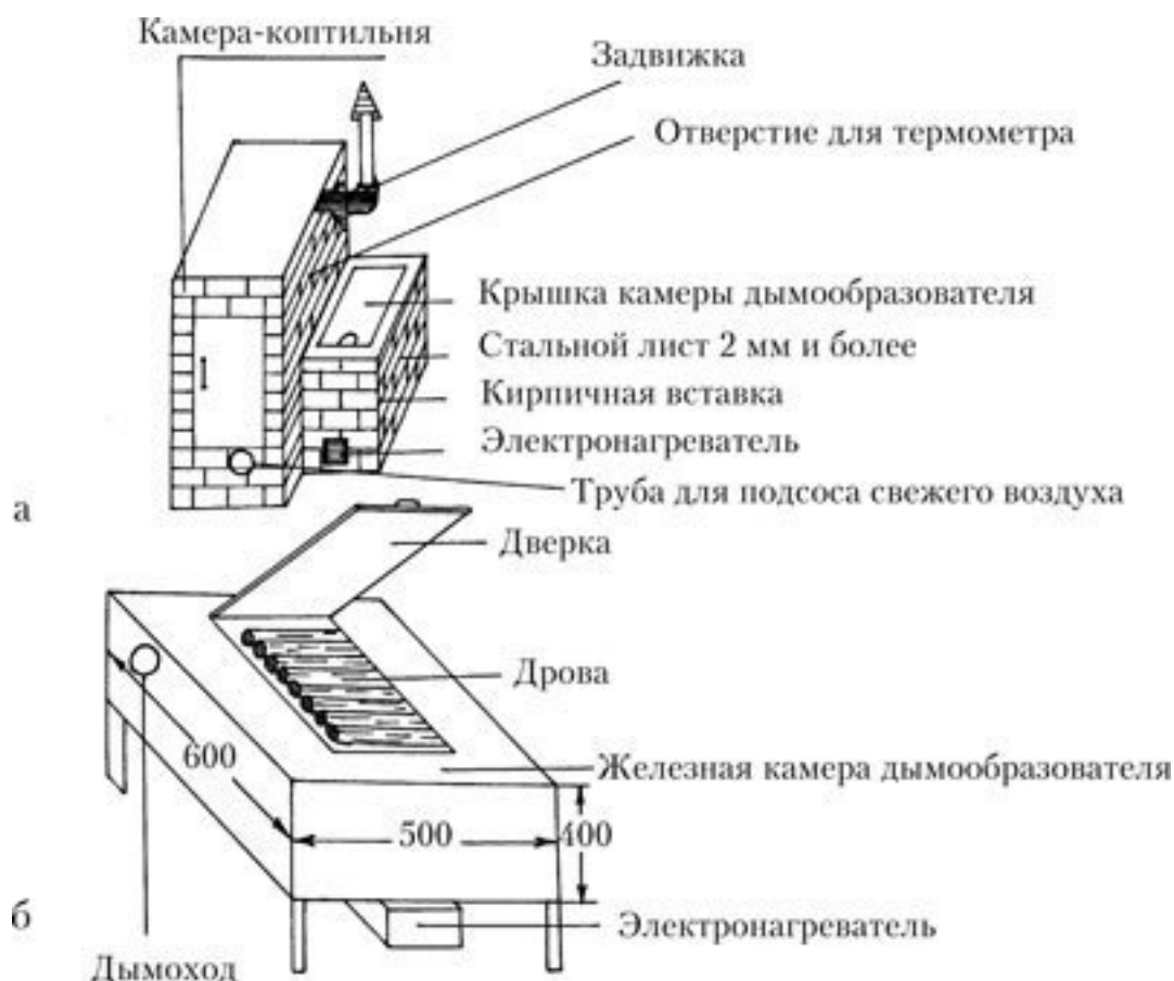
Рис. 12. Домашняя коптильня: а – схема устройства коптильни; б – схема устройства дымообразователя
