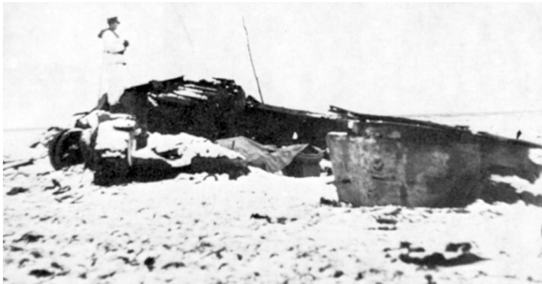
Советский танк Т-34-76, разрушенный внутренним взрывом.
