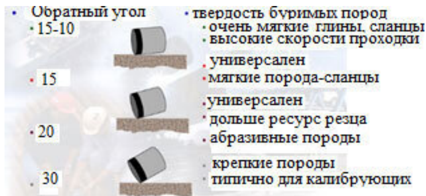
Рис. 5.13. Типовые обратные углы резания
