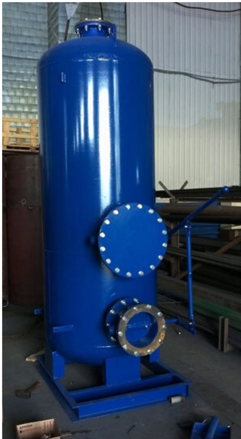
Рис. 2.11. Сепаратор СРБ-2
