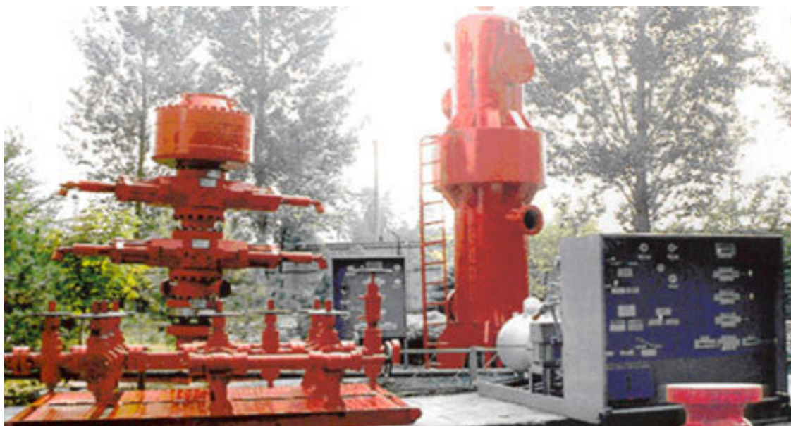
Рис. 2. 14. Превенторная установка
