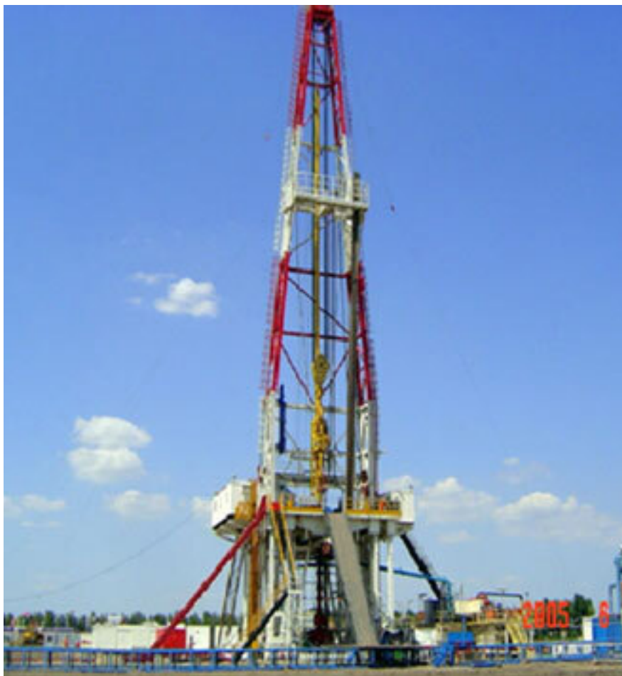
Рис. 2. 1. Буровая установка ZJ 70 KHP
