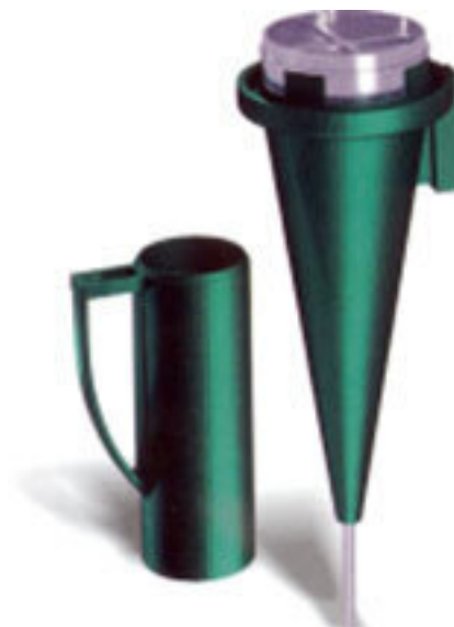
Рис. 8.1. Вискозиметр бурового раствора ВБР-2
